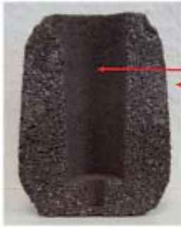
Bild 3: Positionen der Thermoelemente im exothermen Speiser. Position 1: Das Thermoelement befindet sich im unteren Speiserdrittel, direkt in der Schmelze. Dort wird die Temperaturabkühlung im Zentrum des Speisers festgehalten.
