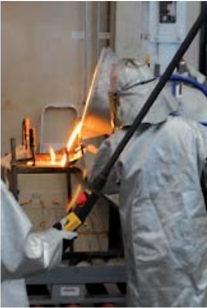
Bild 6: Abguss des Formkastens.
