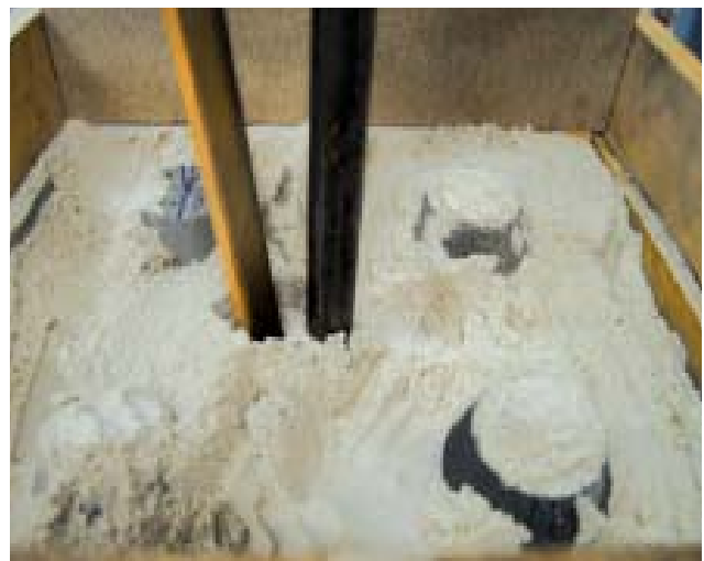
Bild 5: Füllen des Formkastens mit Formsand.
