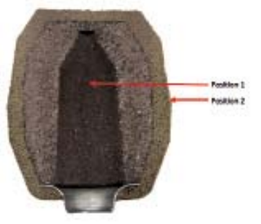
Bild 4: Positionen der Thermoelemente im ECO-Speiser. Position 2: Das Thermoelement befindet sich in einem Abstand von 10 mm zur Speiser-Außenwand und soll dort den Temperaturanstieg des Formsand im Speiserumfeld aufzeichnen.
