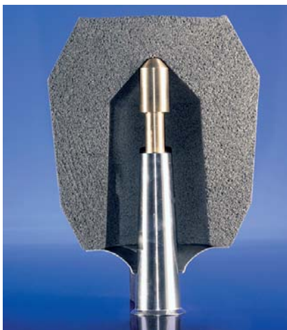
Bild 1: Positionierung eines PX 1332 ME20N vor dem Aufformen
