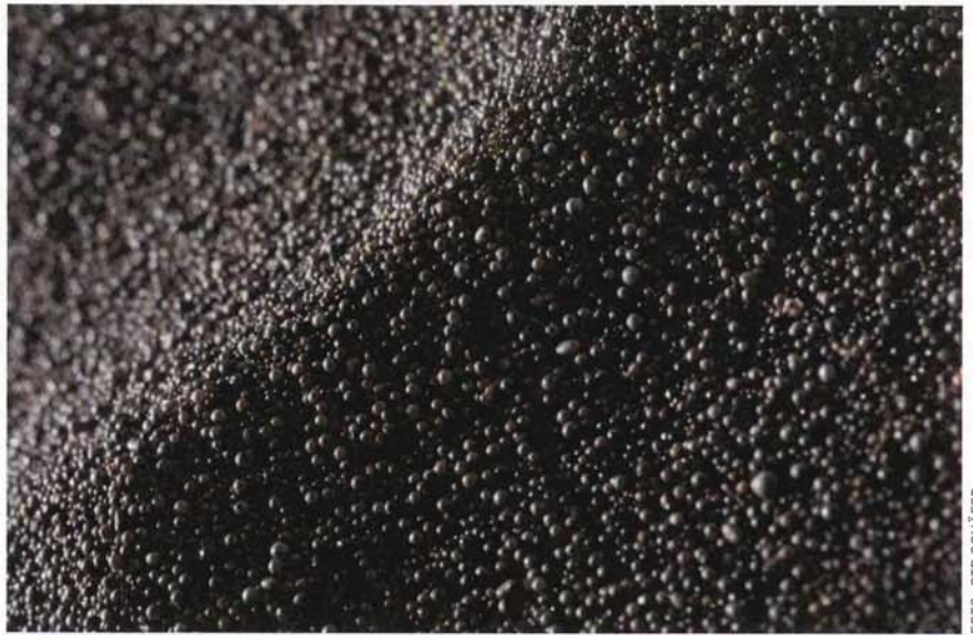
Bild 1: Alternativer Formgrundstoff Ceratec auf Al_2O_3 -Basis.
