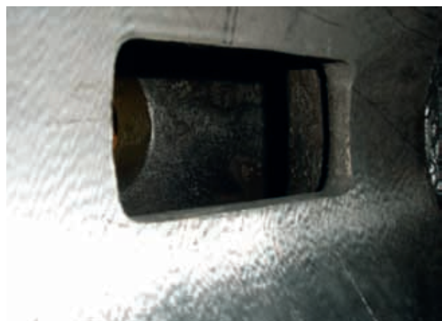
Bild 5: Steuerkanal frei von Verzierungen
