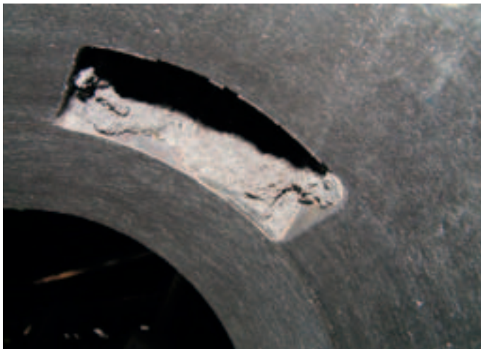
Bild 4: Steuerkanal mit Vererzungen
